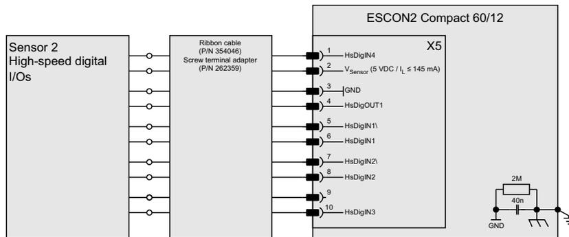
図 4-45 High-speed デジタル I/O
