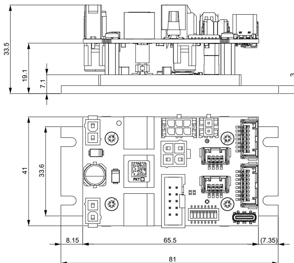
図 2-5 外形寸法図 [mm] (第一角法)
