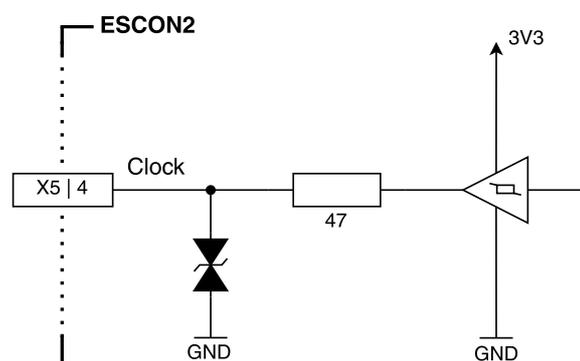
図 3-17 SSI アブソリュートエンコーダ clock 出力回路 (BiSS C も同様)
