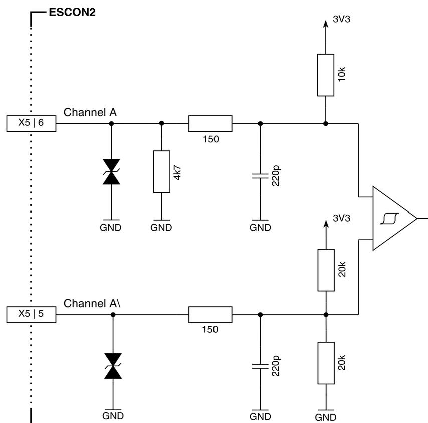
図 3-14 デジタル・インクリメンタルエンコーダ入力回路 Ch A “差動” (Ch B も同様)
