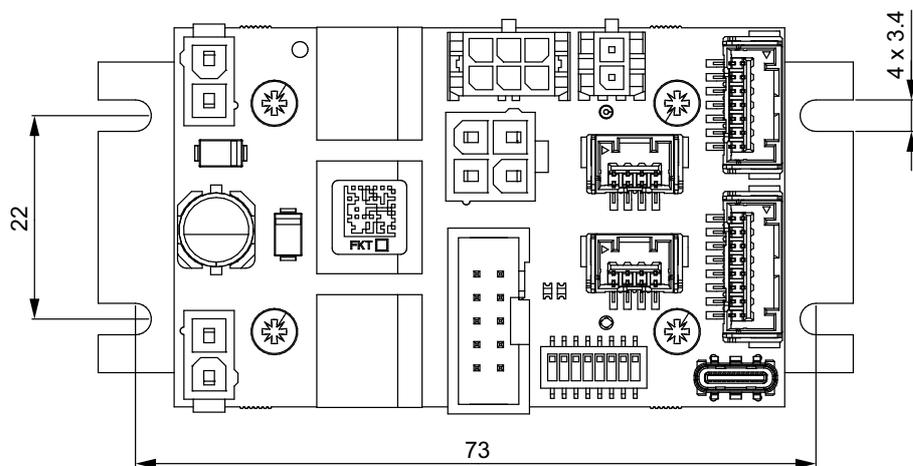
図 2-6 外形寸法図 - 取付位置 [mm]
