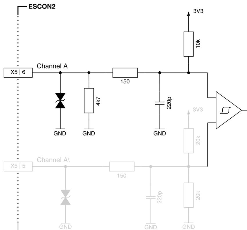
図 3-15 デジタル・インクリメンタルエンコーダ入力回路 Ch A “シングルエンド” (Ch B も同様)
