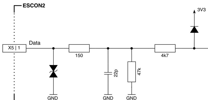
図 3-16 SSI アブソリュートエンコーダ data 入力回路 (BiSS C も同様)
