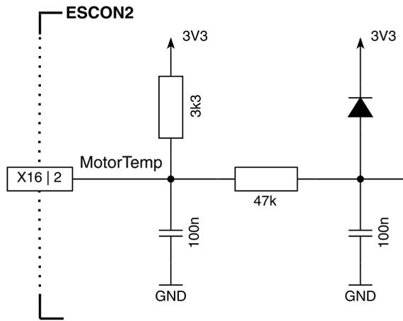
図 3-33 モータ温度センサ回路
