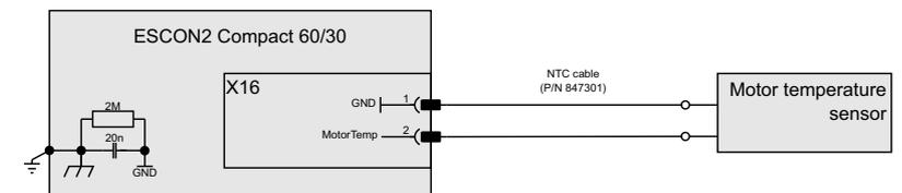
図 4-51 モータ温度センサ
