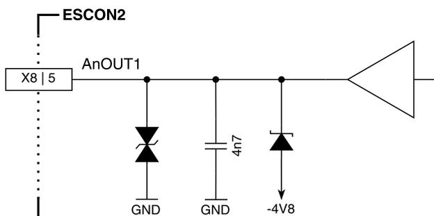
図 3-29 AnOUT1 回路 (AnOUT2 も同様)
