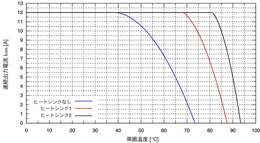
図 2-3 追加ヒートシンク付きでの拡張運転 @ V<sub>CC</sub> 60 VDC
