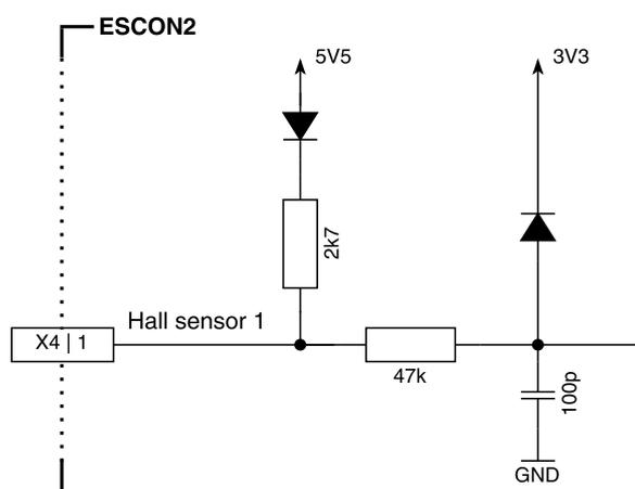
図 3-12 センサ 1 ホールセンサ 1 入力回路 (ホールセンサ 2 および 3 も同様)
