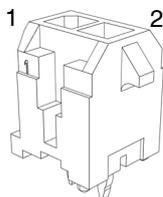
図 3-32 モータ温度センサ コネクタ X16
