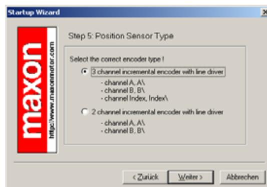
図13: 'Startup wizard' ダイアログ: DC モータのエンコーダ・タイプ選択
