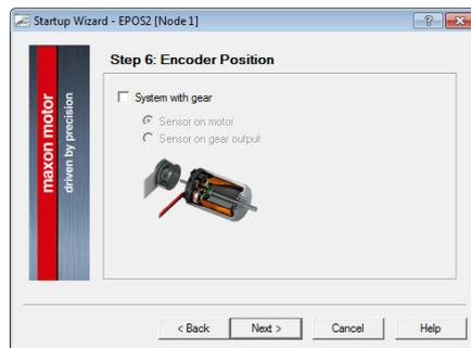
図 3-23 Startup Wizard ダイアログ (DC モータ) : エンコーダ取付位置
