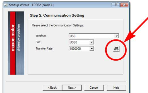
図 3-12 Startup Wizard ダイアログ : USB 通信
